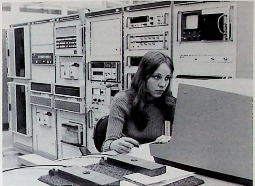
In der Prüfung ist, wie auch in der Fertigung, ein hoher Automatisierungsgrad erforderlich, um die Qualität hochwertiger Produkte sicherzustellen. AEG-Telefunken wendet Systeme unter Zuhilfenahme von Rechnern an. Unser Bild zeigt die rechnergeführte Endprüfung von Handsprechfunkgeräten.
