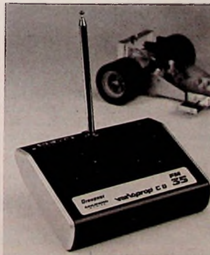
Bild 1. 8-Kanal-FM-Schmalband-Fernlenkanlage „Varioprop C 8 FM 35“ für 20 HF-Kanäle im 35-MHz-Band
